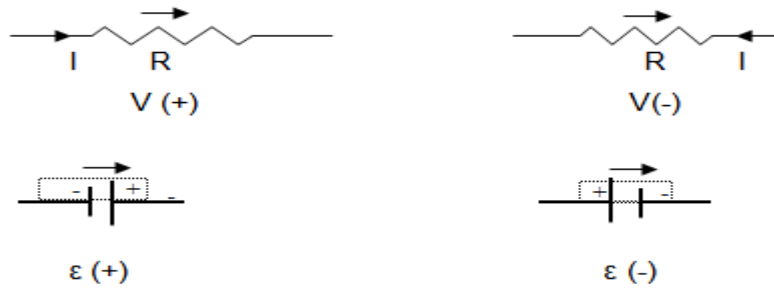
Gambar 22. Arah arus yang melalui resistor dan sumber GGL
